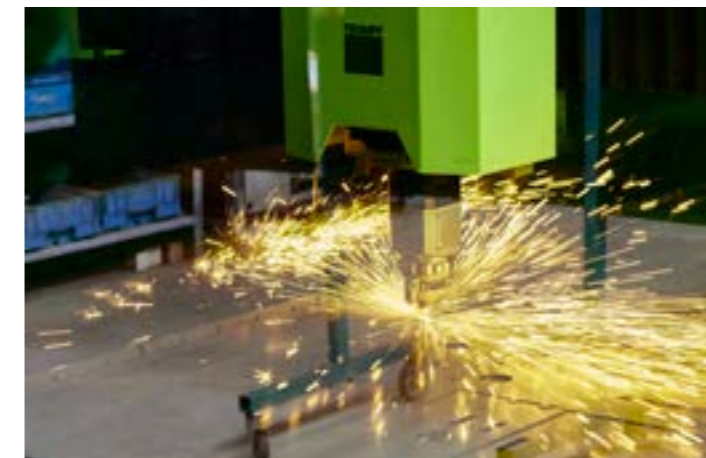
Ein Hochleistungslaser schneidet Stahl millimetergenau. | A high-power laser cuts steel with millimeter precision.
