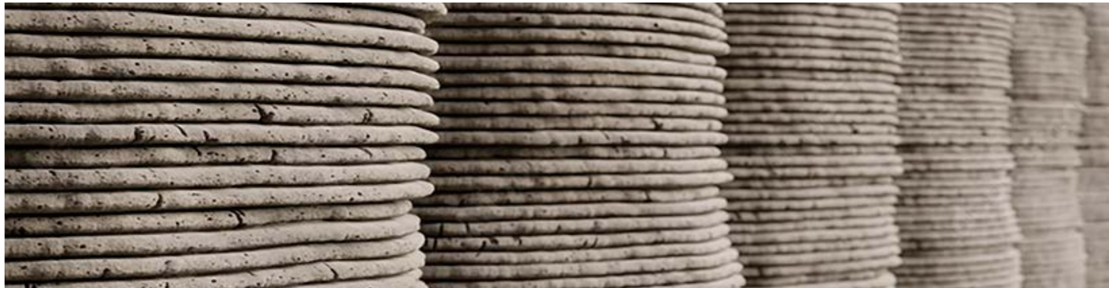
3D-Beton-Verarbeitung ermöglicht individuelle Formgebungen auch in Kleinmengen | 3D Concrete Printing enables individual shaping even in small quantities
