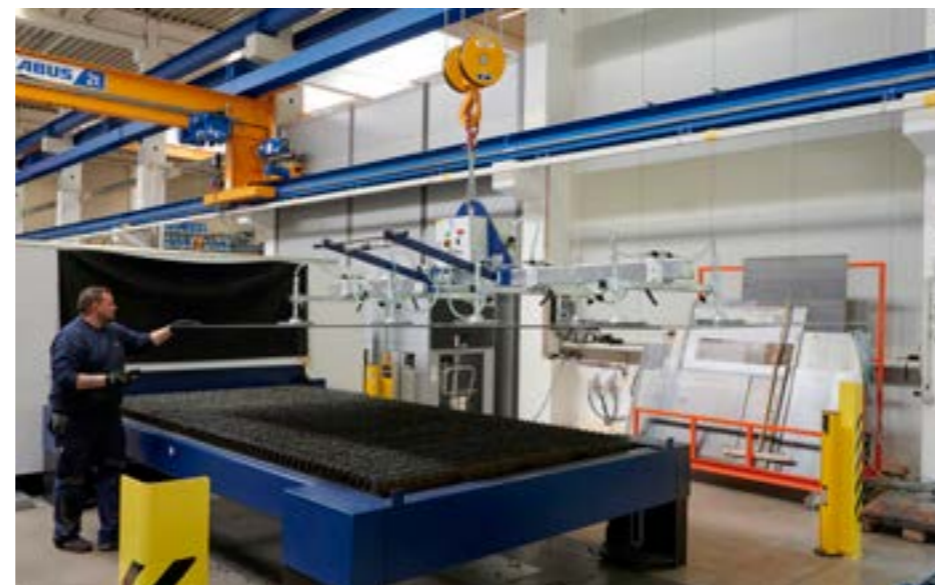
Zuführung einer Blechtafel in die Laserschneide-Anlage der Fa. TRUMPF | Feeding of a steel plate into the TRUMPF laser cutting system
